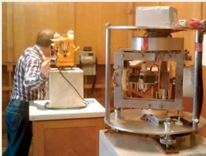
Figure 5.7 : Au premier plan, le théodolite Diflux automatique AUTODIF MKII. Derrière, un observateur effectue une mesure manuelle avec un Diflux ZEISS010. L'AUTODIF est destiné à remplacer le théodolite manuel dans les observatoires automatiques.
