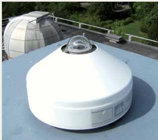
Figure 5.9: Pyranomètre sur la tour radiométrique de l'IRM à Uccle.
