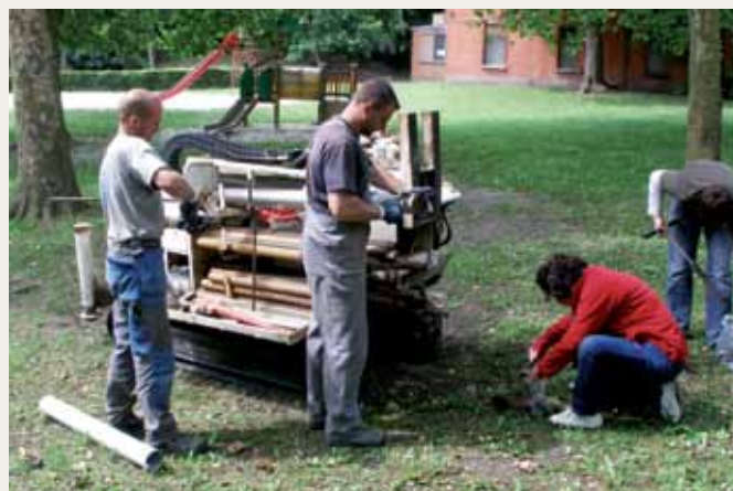
Figure 5.11 : Prélèvement d'un échantillon de sol dans le cadre du projet Pollusol en collaboration avec la SPAQuE et l'Université Catholique de Louvain. Lors de l'extraction de la carotte qui servira d'échantillon pour les analyses chimiques du sol, d'autres échantillons sont prélevés autour du trou percé au foret pour des analyses magnétiques, afin de garantir leur compatibilité.
