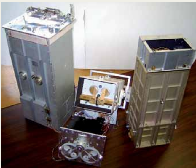
Figure 2.3 : Quelques-uns des instruments de mesure de l'irradiance solaire appartenant au riche passé de l'IRM. À gauche : l'instrument SOVA, qui a été ramené de l'espace par la navette spatiale après un vol de 8 mois sur le satellite Eureka. Au centre, à l'arrière : instrument CR 3 qui a participé au World Reference Group pour les mesures à partir du sol. L'instrument similaire CR 2 fait toujours partie du même World Reference Group. Au centre à l'avant : l'instrument Diarad/Sovim lancé en 2008, qui se trouve aujourd'hui à bord de la Station Spatiale Internationale. À droite : notre premier instrument spatial, le Solcon-1 qui a participé au vol de Spacelab en 1983.
