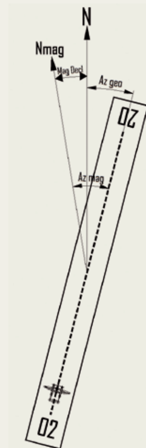
Figure 2.6 : Schéma de la piste d'envol 02/20 de Brussels Airport avec indication des azimuts géographique (Az geo) et magnétique (Az mag). N et Nmag correspondent respectivement aux nord géographique et magnétique. La déclinaison magnétique (Mag Decl) a été exagérée pour les besoins du dessin.
