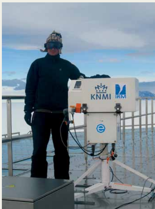
Figure 3.6 : Le scientifique de l'IRM, A. Mangold, sur le toit de la station Princess Elisabeth avec le spectrophotomètre d'ozone Brewer. L'instrument nous a été offert par nos collègues néerlandais du Koninklijk Nederlands Meteorologisch Instituut.
